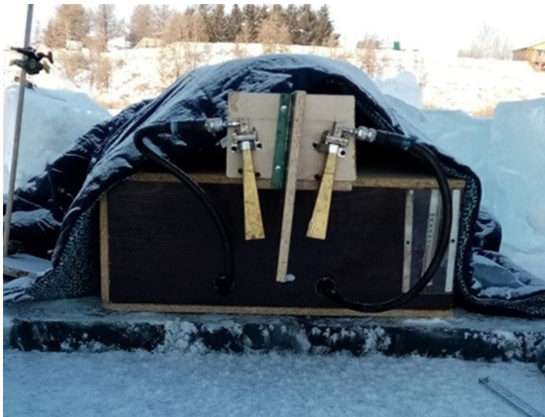
Рис. 4. Фото экспериментальной установки по измерению коэффициента отражения
